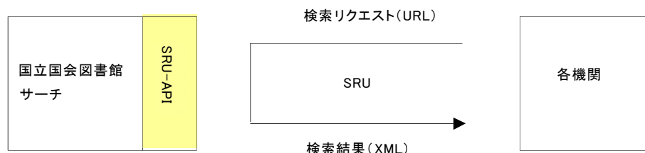
図 3-1 SRU 提供インタフェースの概要
