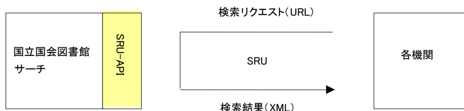
図 3-1 SRU 提供インタフェースの概要
